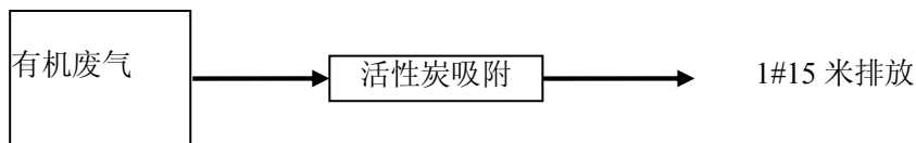
图 4-2 聚乙烯交联料生产线废气处理流程及监测点位图
